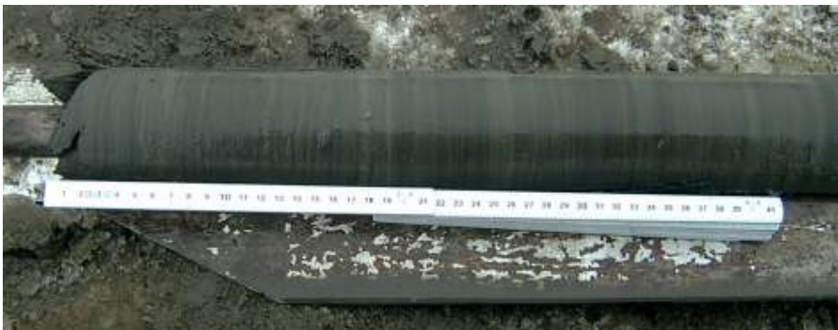
Kuva 8. Valkjärven sedimenttiä syvyydeltä 3,95-4,40 metriä sedimentin pinnasta. Havaittavissa on selvää raidallisuutta.
