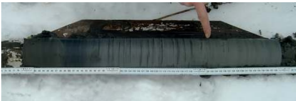
Kuva 7. Joutsijärven sedimentin muuttuminen sulfidien tasaisesti värjäämästä savesta sulfidiraitaiseksi saveksi syvyydellä 2,39-2,99 metriä.
