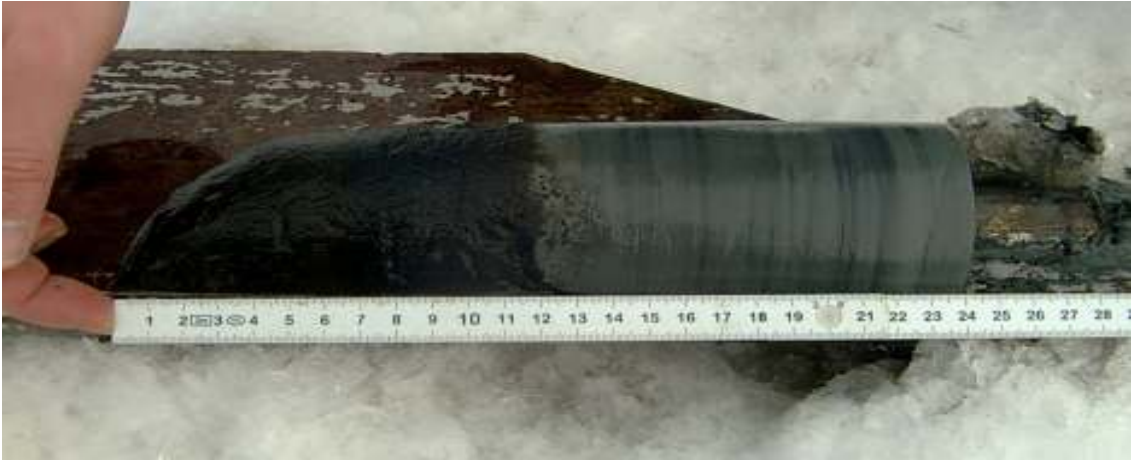
Kuva 5. Joutsijärven sedimenttinäytteen ylin osa, jossa näkyy löyhän järvisedimentin ja sulfidiraitaisen saven terävä kontakti.
